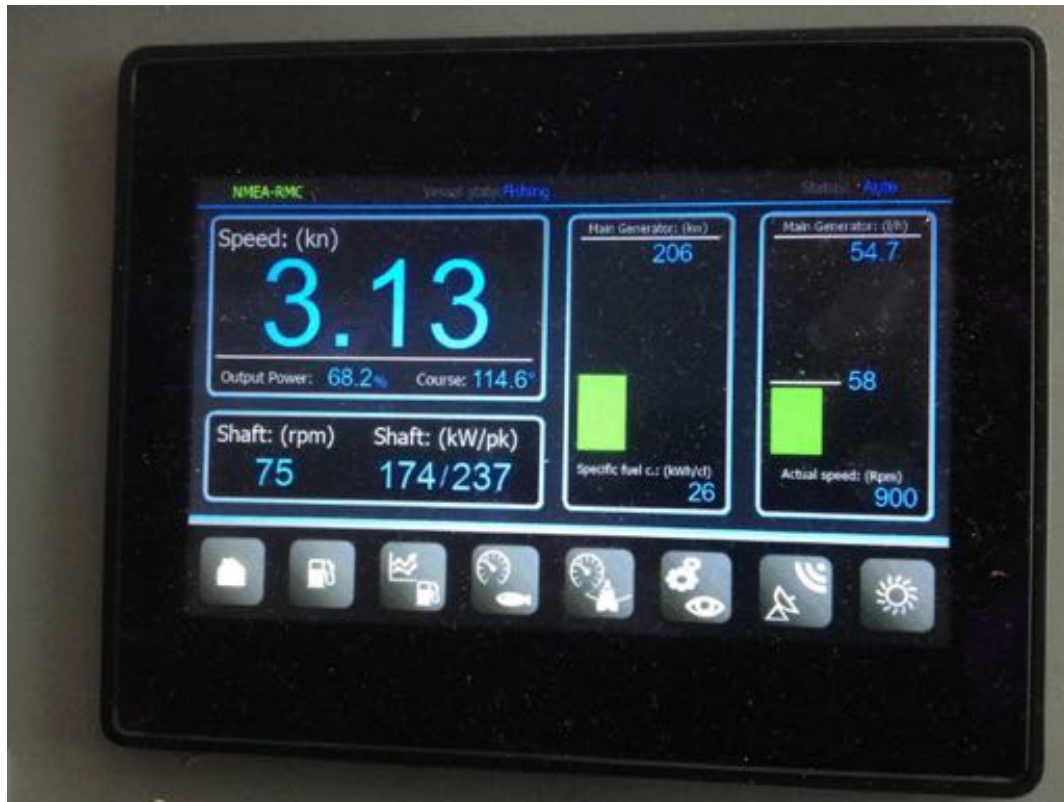
Foto 2. Het scherm van de brandstofverbruiksmeter. Bij een snelheid van 3.13 kn bedroeg het verbruik op deze momentopname 58 l/h.
